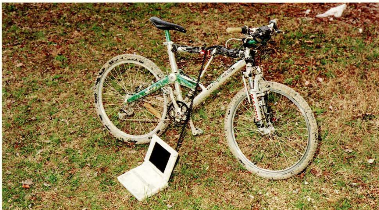
ACQUISIZIONE DATI PER PROVA FORCELLA. DATA ACQUISITION FOR FORK TEST.
