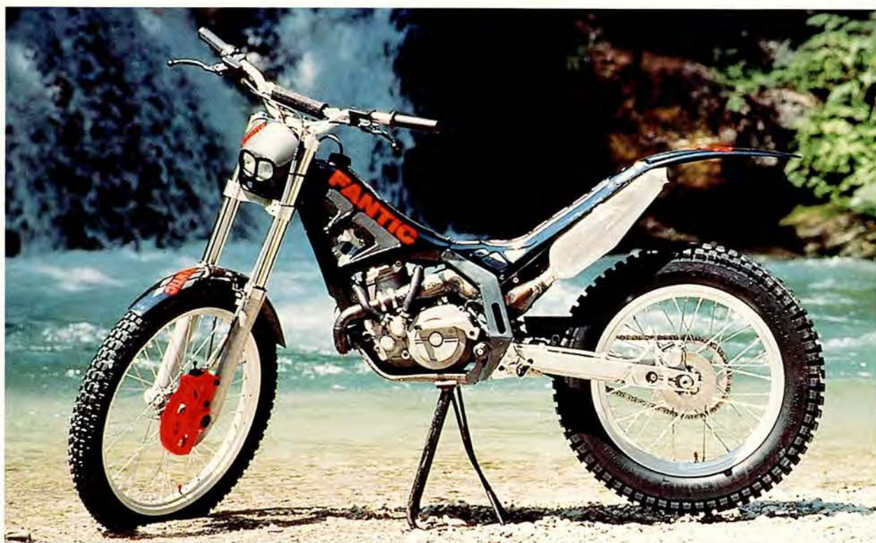
FANTIC TRIAL EQUIPAGGIATA CON FORCELLA PA M1. FANTIC TRIAL, EQUIPPED WITH PA M1 FORK.
