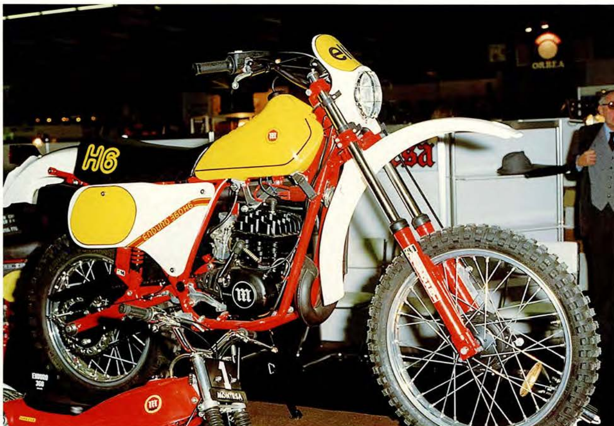
MONTESA ENDURO, CON FORCELLA A PERNO CENTRALE CON CORSA DI 252 mm E CROCERA AD ALA DI GABBIANO.
